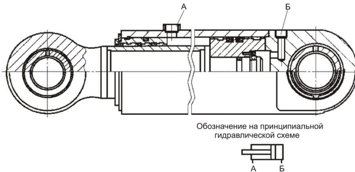
Рисунок 23 – Гидроцилиндр выдвижения балки выносной опоры
