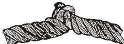
Рисунок Ж.8 Перекручивание каната
