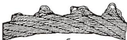
Рисунок Ж.4 Выдавливание проволок прядей: а - в одной пряди; б - в нескольких прядях
